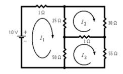
$$\begin{cases} 76i_1 - 25i_2 - 50i_3 = 10 \\ -25i_1 + 56i_2 - 1i_3 = 0 \\ -50i_1 - 1i_2 + 106i_3 = 0 \end{cases}$$
